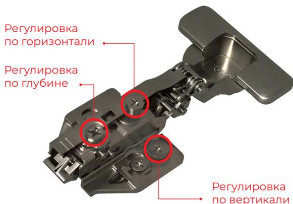
**Положение фасада корректируется в трёх измерениях:** по глубине, по ширине и по высоте. Для удобства монтажа на теле петли предусмотрены стрелки, обозначающие соответствующие регулировки.
